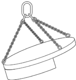
Bild 14: Det mesta av lasten bärs upp av en kättingslinga
