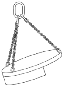
Bild 15: Det mesta av lasten bärs upp av två kättingslingor
