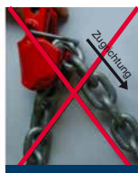
falsch eingehängte Kette
