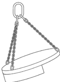
Illustrasjon 15: Størstedelen av godset bæres av to kjettingarter
